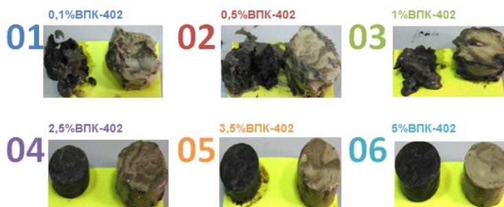
Рис. 1. Исследования по определению стабилизирующих свойств катионного полимера
