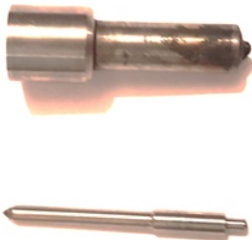
Рис. 1. Изношенный распылитель форсунки
