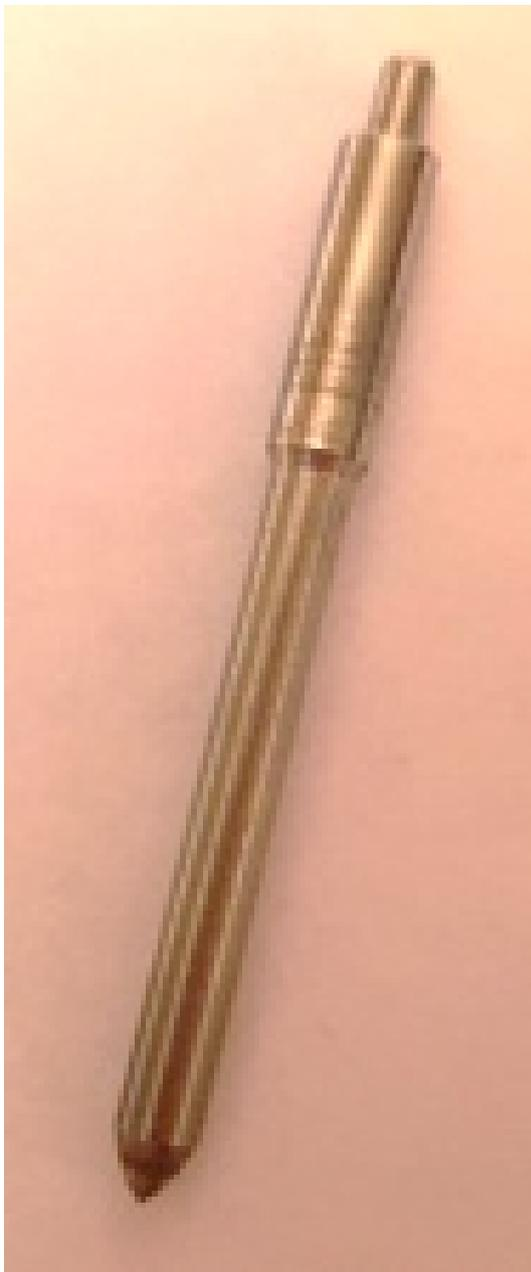
**Рис. 2.** изношенна игла форсунки
